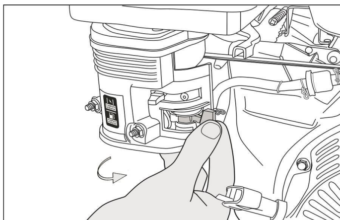
Рис. 21. Открытие топливного крана
