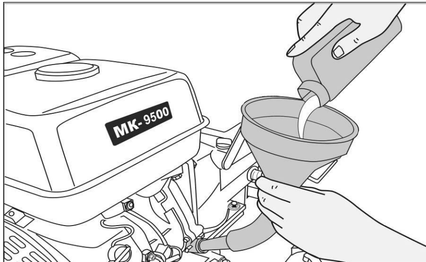
Рис. 17. Заливка масла в двигатель
