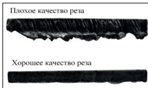
Рис.4 Влияние силы тока и скорости реза.
