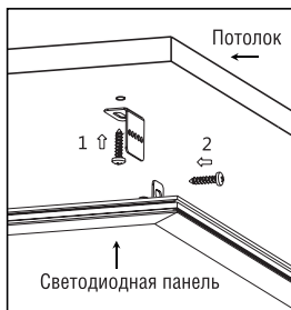
– Рисунок 4. Монтаж при помощи комплекта LP-KPP-D –
