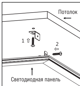
– Рисунок 3. Монтаж при помощи комплекта LP-KPP-K –
